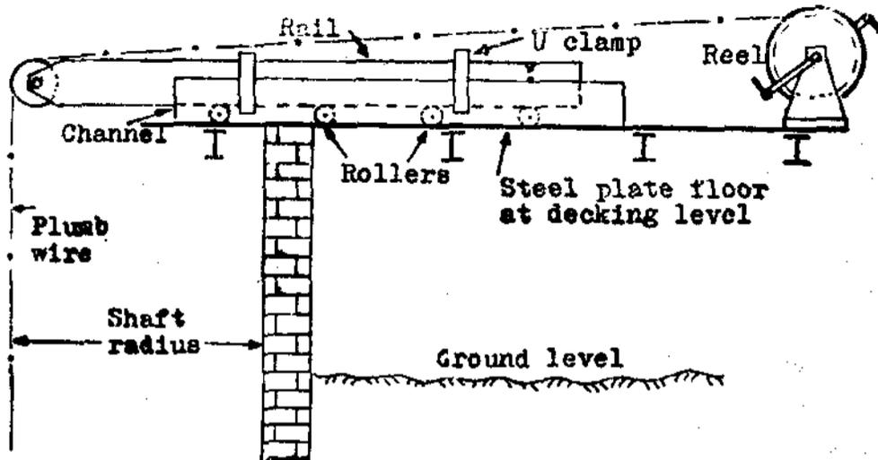
Fig. 4.9. Shaft centering arrangement.
